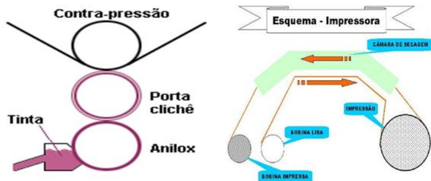
FIGURA 1 - ESQUEMA DE IMPRESSÃO FLEXOGRÁFICA
